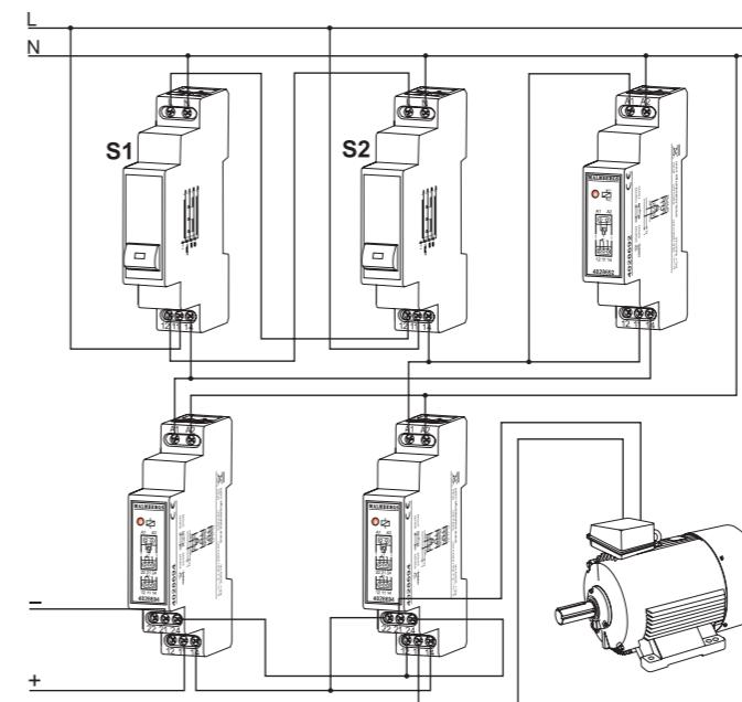
**Styrsystem för motor med växling av varvriktning.**
